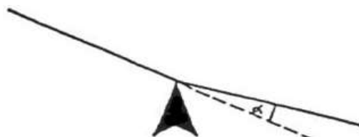
Obr. 16.70. Úhel lomu lana na podpěrné botce (negativní)
