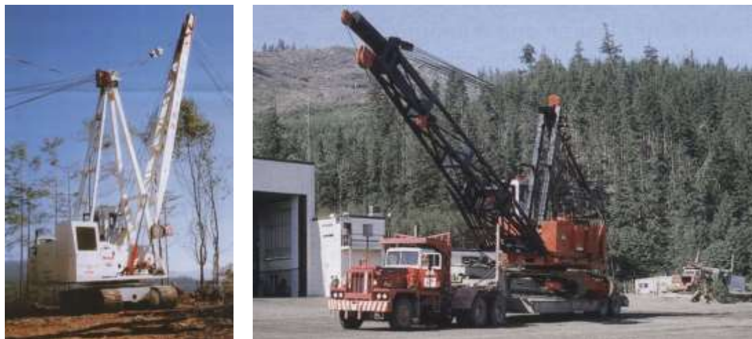
Obr. 18.9. Yarder (swing yarder) a jeho převoz
