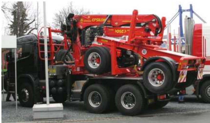
Obr. 19.39. Zpětná přeprava odvozní soupravy s polopřívěsem naloženým na tažném vozidle
