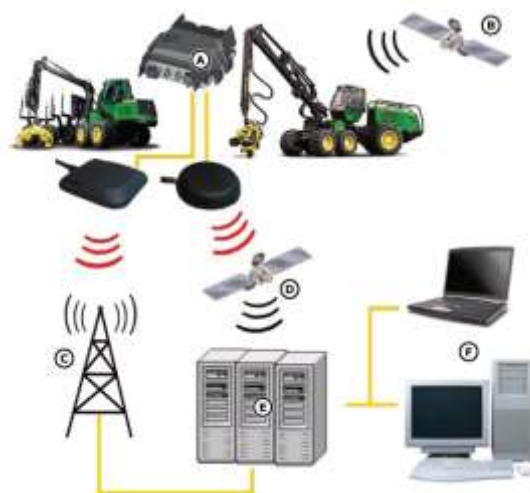
Obr. 21.2. Proces komunikace harvestorového uzlu (John Deere)
