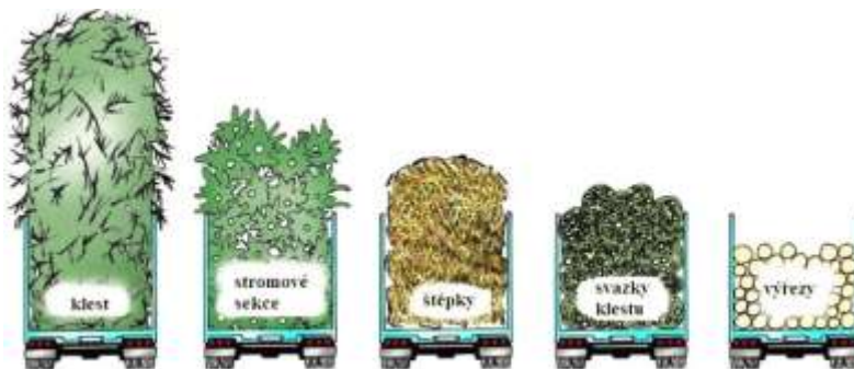
Obr. 23.17. Využití odvozní kapacity vozidla při transportu různého materiálu (John Deere)
