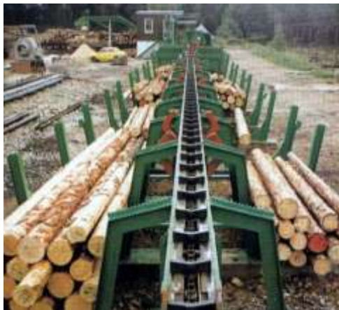
Obr. 20.4a. Manipulační linka – podélný dopravník a třídící boxy
