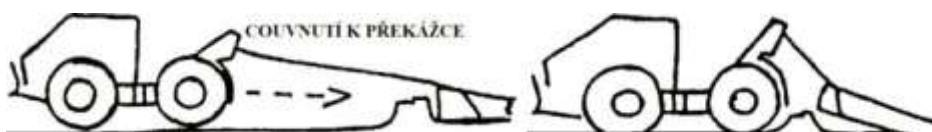
Obr. 15.74. Překonávání překážky přizdvížením nákladu
