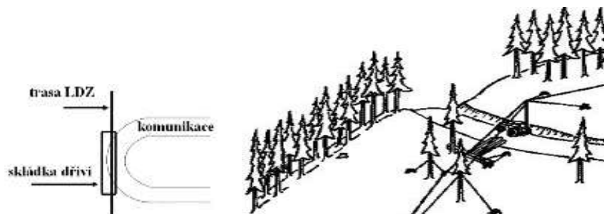
Obr. 16.62. Varianty skládkování pod nosným lanem
