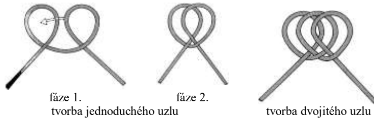
16.13. Tvorba jednoduchého a dvojitého uzlu pro kotvení na pařezy
