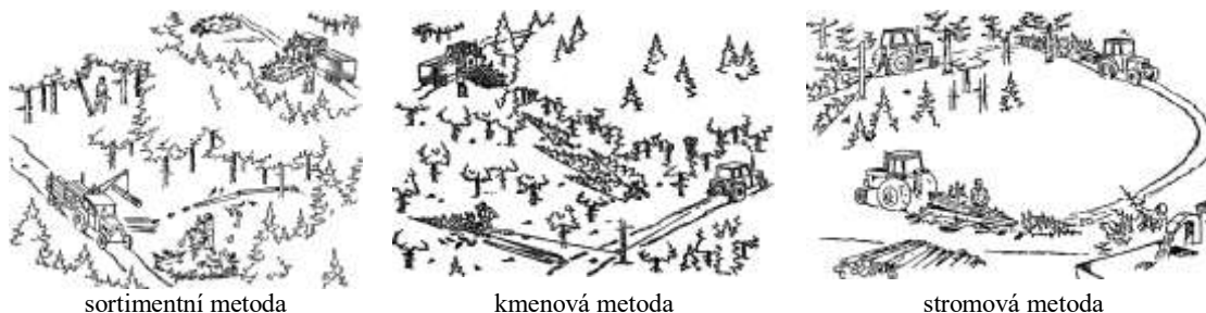
Obr. 23.16. Malovýrobní technologie štěpkování v různých těžebních metodách
