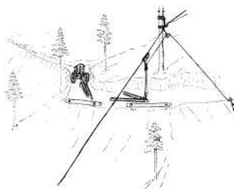
Obr. 16.26. Odtahování od nosného lana traktorem
