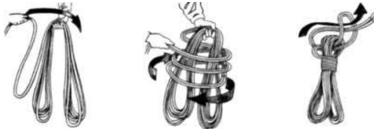
Obr. 16.96. Postup skládání textilního lana do svitku
