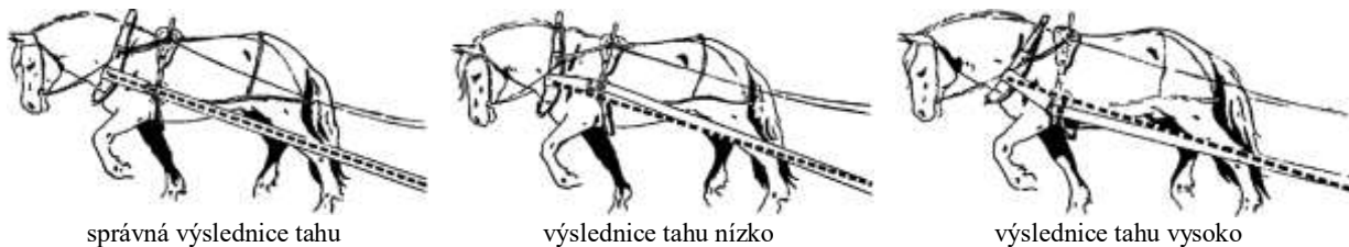
Obr. 15.19. Regulace souslednosti tahu a pobočiny
