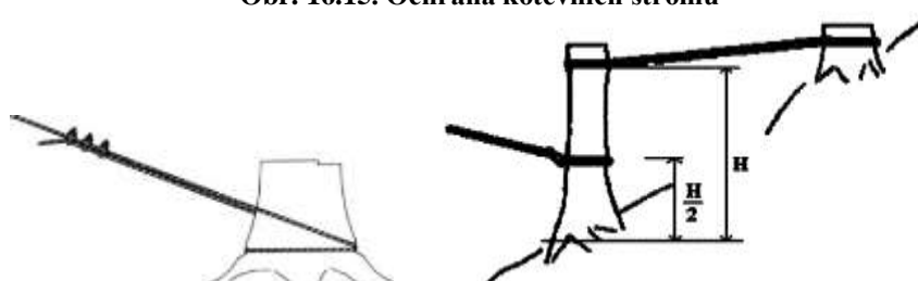
Obr. 16.16. Kotvení na pařezy
