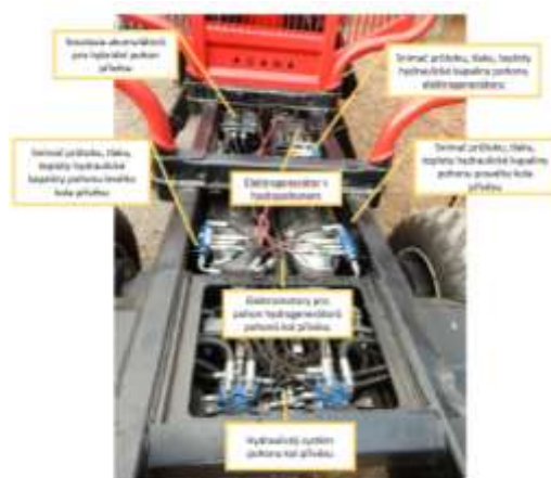
Obr. 15.99. Funkční celky hybridního pohonu podvozku přívěsu LV10 HP
