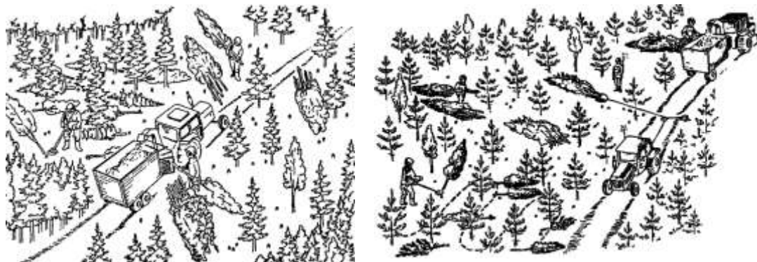
Obr. 23.15. Malovýrobní technologie štěpkování celých stromů ve výchovném zásahu
