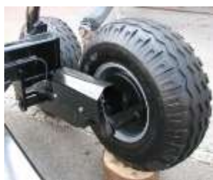
Obr. 15.90. Nepoháněná a pastorkem poháněná bogie náprava
