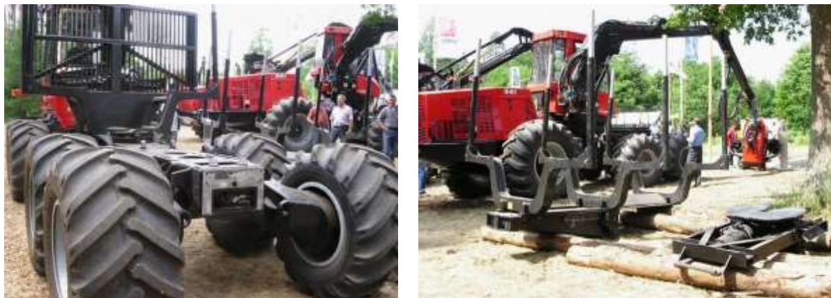
Obr. 18.8. Základový stroj Valmet s výměnnými nástavbami
