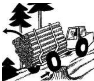
Obr. 15.101. Nájezd na pařez může mít za následek převrácení stroje, nebo poškození stromu u linky
