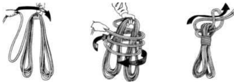
Obr. 15.40. Postup skládání textilního lana do svitku
