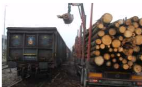
Obr. 20.14. Nakládání dříví do vagonu hydraulickým jeřábem odvozní automobilní soupravy
