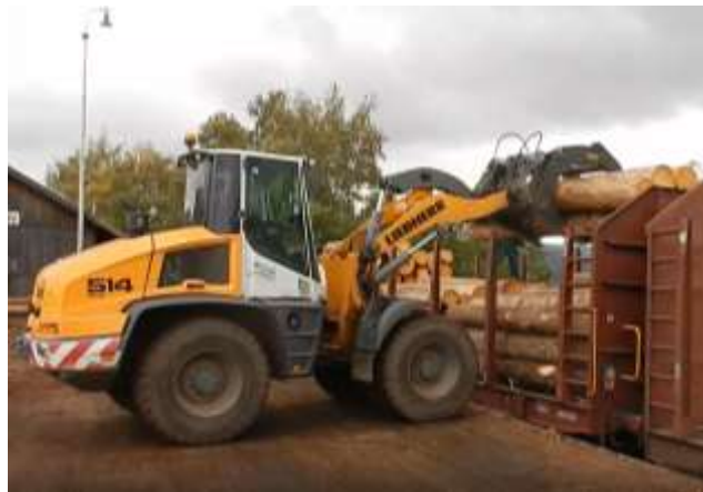
Obr. 20.4b. Nakládání výřezů dříví do klanicových vagonů čelním nakladačem
