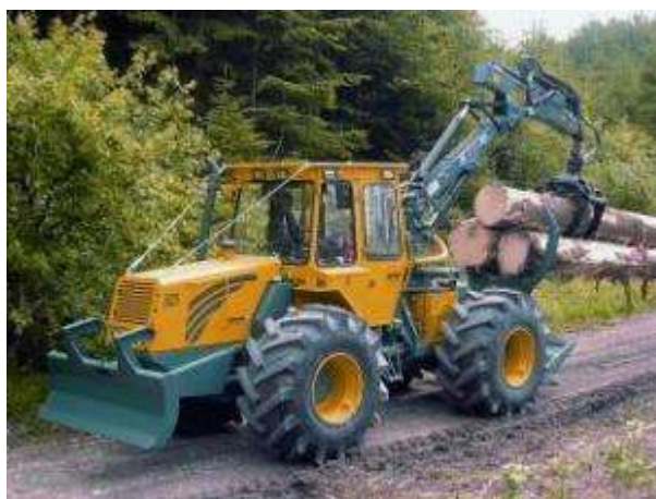
Obr. 15.87. Tahač HSM 805 se svěrným oplenem, drapákem na hydraulickém jeřábu a navijákem
