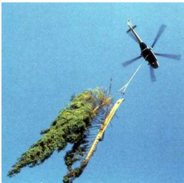
Obr. 17.1. Vrtulník Mi-8 dopravující celé stromy ve visu
