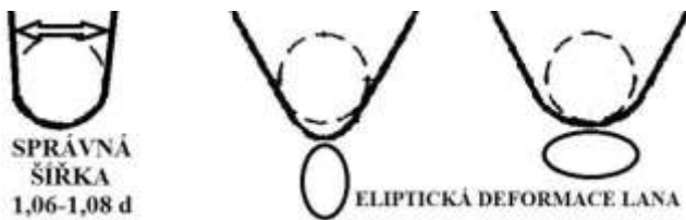
Obr. 15.70. Ideální a nevhodná šířka drážky kladky
