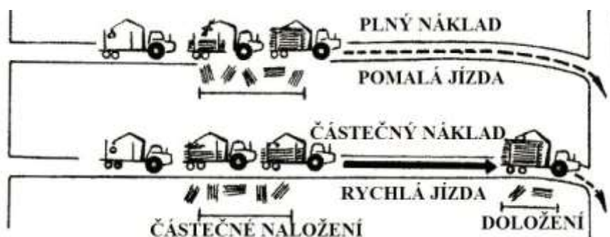
Obr. 15.103. Schéma nakládání a jízdy vyvázeče
