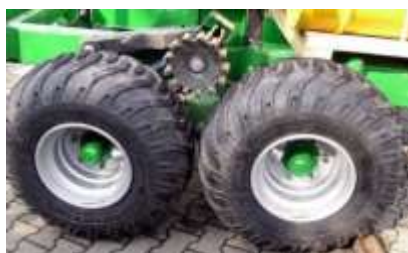
Obr. 15.90. Nepoháněná a pastorkem poháněná bogie náprava
