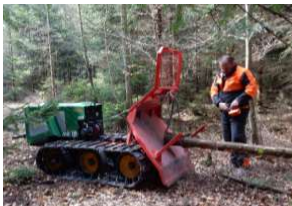
Obr. 15.51. Malý přibližovací pásový stroj MK-18 a způsob jeho využití
