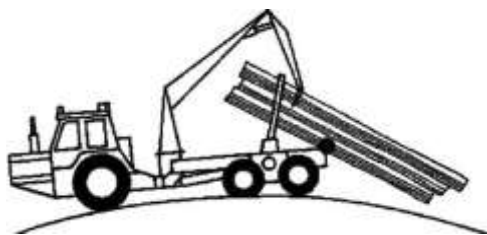
Obr. 15.85. Přetížení zadní nápravy v konvexním oblouku
