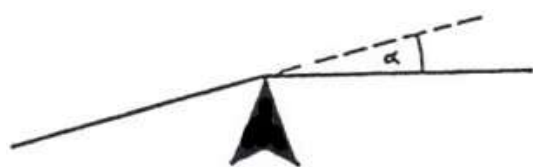
Obr. 16.69. Úhel lomu lana na podpěrné botce (pozitivní)
