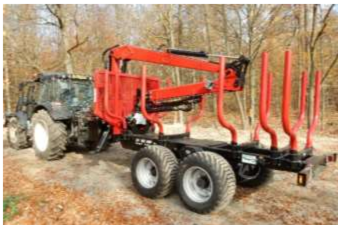
Obr. 15.98. Prototyp vyvážecího přívěsu LV10 HP s hybridním pohonem podvozku
