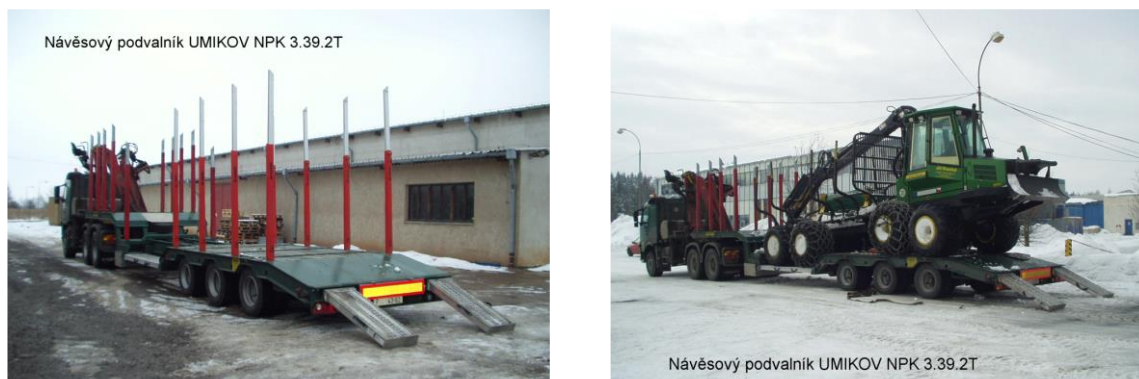
Obr. 11.8. Návěsový podvalník pro převoz dříví i strojů (vpravo s přepravovaným harvestorem)
