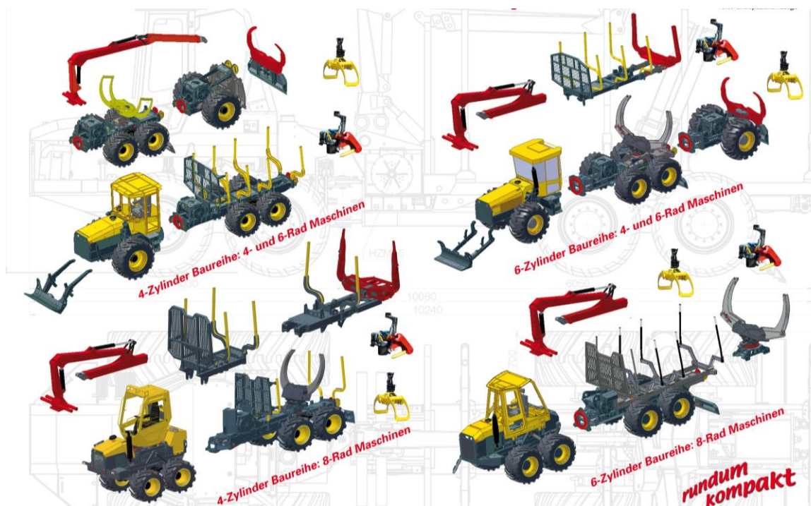
Obr. 4.39. Variabilita ložného prostoru vyvážecího traktoru (Welte)
