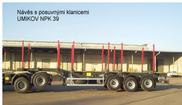
Obr. 11.6. Třínápravový návěs s posuvnými klanicemi
