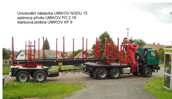
Obr. 11.2. Univerzální nástavba pro odvoz dříví
