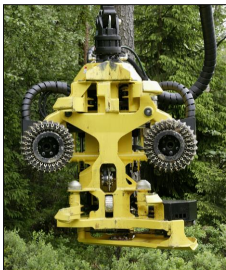
Obr. 4.29.1. Harvestorová hlavice švédského typu JD H752
