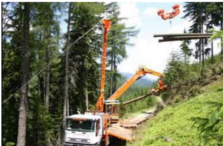
Obr. 7.25. Horský procesor Syncrofalke
