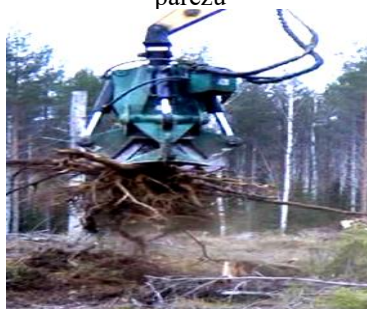
Obr. 8.7. Úkony vykonávané při klučení pařezů čelist'ovou hlavicí
