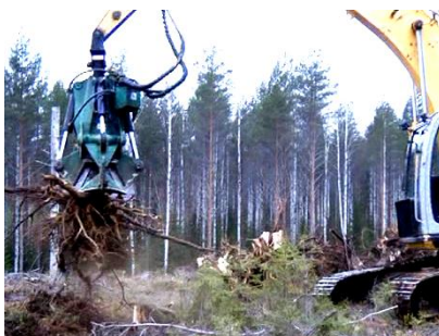
Obr. 8.7. Úkony vykonávané při klučení pařezů čelist'ovou hlavicí
