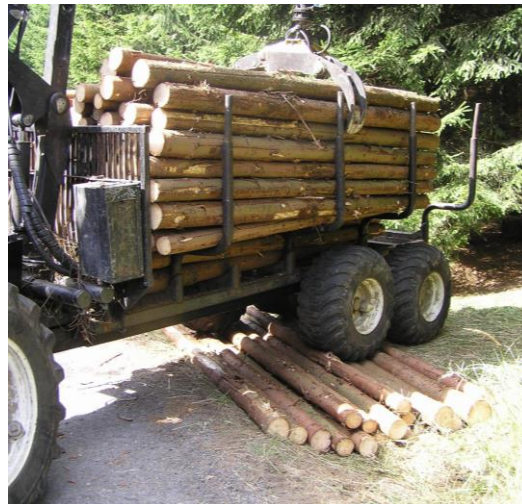
Obr. 6.8.2. Dočasným vyplněním příkopu výřezy dříví je umožněn bezeškový průjezd strojů do a z porostu
