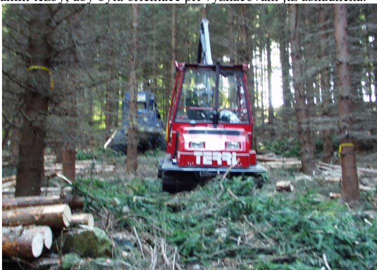
Obr. 6.9. Vyznačení krajních stromů linky páskou je dobře viditelné, uložení těžebních zbytků na lince je v dostatečné vrstvě tak, aby nebyl narušen kořenový systém okrajových stromů
