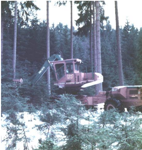
Obr. 2.4. Kácací stroj ÖSA 670
