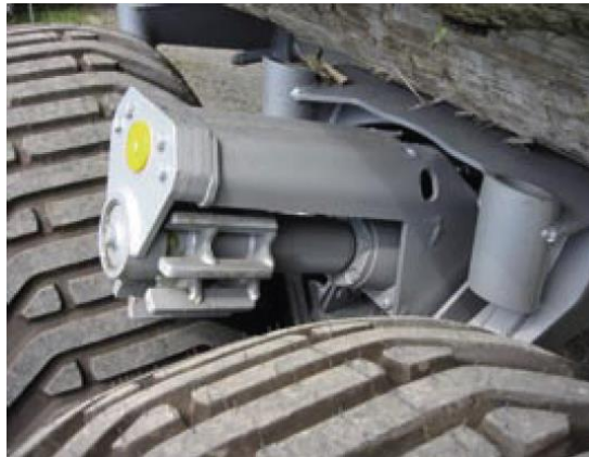
Obr. 4.40. Tandemová náprava poháněná trakčními válečky
