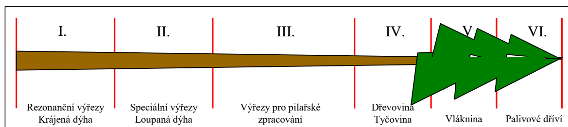
Obr. 3.1. Jakostní třídění dříví – příklad rozčlenění částí kmene do sortimentů
