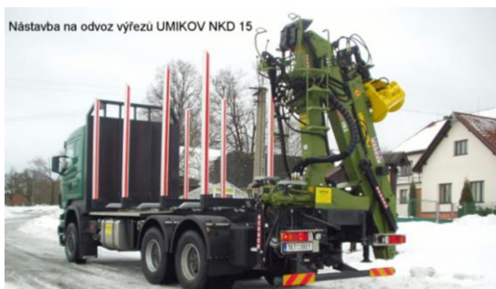
Obr. 11.1. Nástavba bez podlahy pro odvoz krátkých sortimentů dříví
