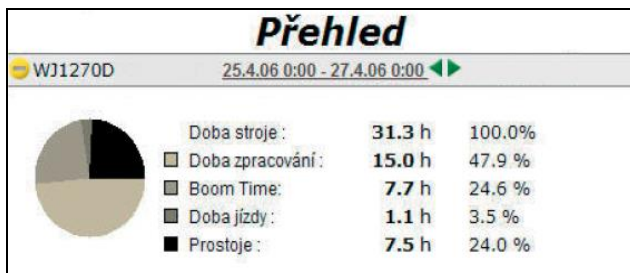
Obr. 5.8. Rozdělení pracovní doby stroje monitorované programem TimberLink (John Deere)
