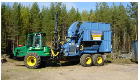
8.5. Mobilní štěpkovač Bruks Klöckner 805 CT s kontejnerem na štěpku na podvozku 6-tí kolového vyvážecího traktoru
