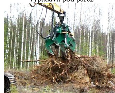
Obr. 8.7. Úkony vykonávané při klučení pařezů čelist'ovou hlavicí
