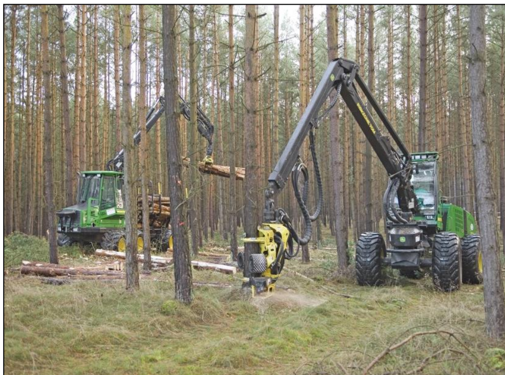
Obr. 3.2. Těžba dříví harvestorovým uzlem
