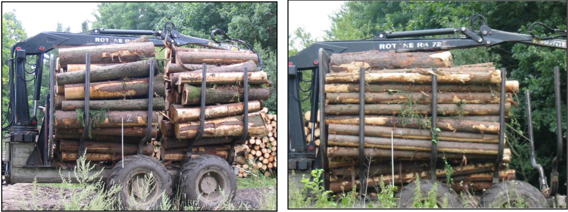
Obr. 12.4. Množství dříví vyvezené na 1 jízdu závisí na délce vyvážených sortimentů. Za řadu sortimentů s délkou 2 m (vlevo) lze uložit ještě další řadu sortimentů s délkou 2 nebo 2,5 m. Tento způsob nelze použít pro malou délku ložného prostoru vyvážeče při délce výřezů 3 m (vpravo). Celkový objem nákladu je pak o čtvrtinu menší než u 4 m výřezů.
