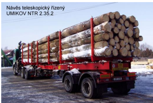
Obr. 11.5. Dvounápravový návěs teleskopický řízený
