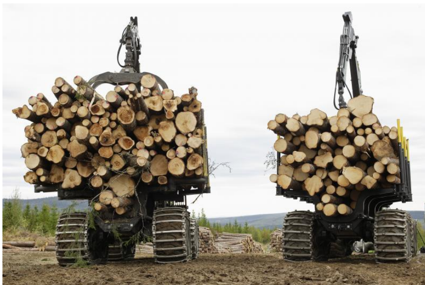
Obr. 4.38. Systém ALS s maximální a minimální plochou příčného průřezu ložné plochy
