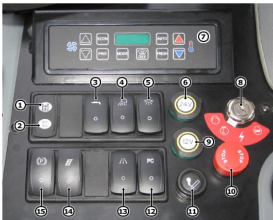
Obr. 7.1. Umístění nouzového tlačítka na bočním ovládacím panelu (č. 10)
