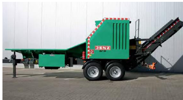
8.6. Mobilní drtič Jenz AZ 30 D s pásovým dopravníkem
