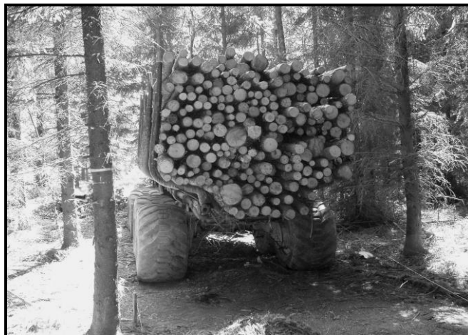
Obr. 6.4. Vyvázeční linka s malou šířkou, vhodná jen pro koně nebo UKT
