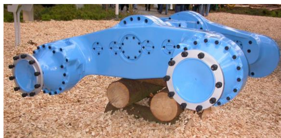
Obr. 4.13. Tandemová (bogie) náprava
