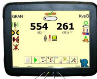
Obr. 5.2. Pracovní režim dotykového displeje měřicího a řídicího systému Rotne D5
