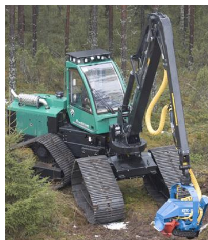
Obr. 4.18. Čtyři pásové jednotky harvestoru ProSilva
